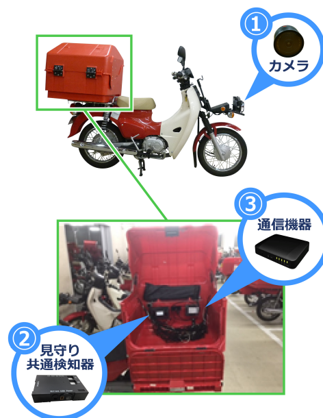
郵便バイクへの IoT 機器取付け状況
